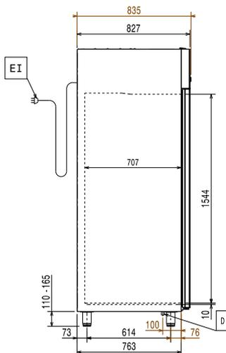
ED = separater Elektroanschluss      RO = Zentralkälteanlage-Anschluss
